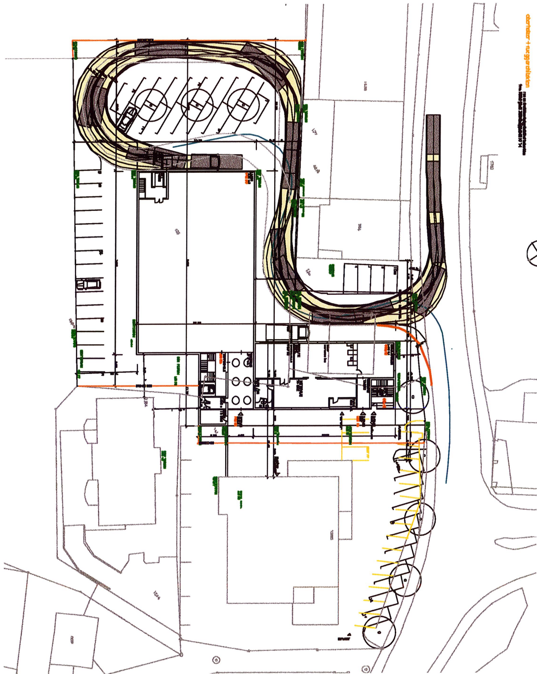
Abbildung 3: Einfahrt mit Benutzung Gegenfahrstreifen Uznacherstrasse
